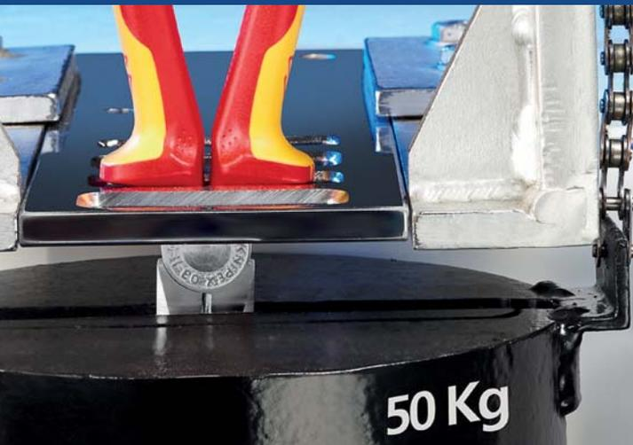
Control de la capacidad de adherencia del revestimiento aislante con 500 N.
