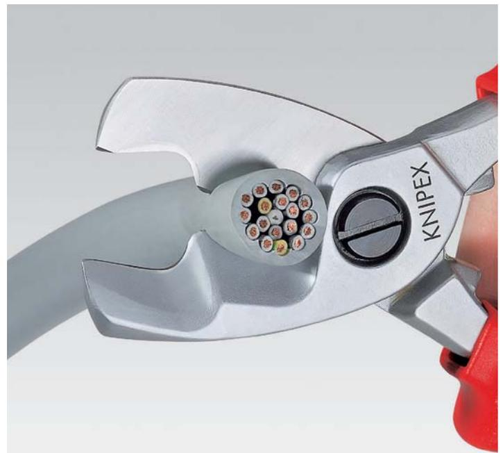
**Corte final:** Después de haber cortado el aislamiento del cable con el filo delantero, los conductores se cortan en el perfil trasero. Corte inicial delante, corte final atrás – de este modo se corta con más facilidad.
