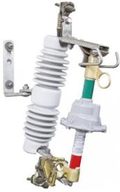
El seccionizador cuenta las operaciones del equipo de protección después de detectar una condición de falla. Después de un número seleccionado de aperturas del equipo de protección asociado y cuando éste está abierto, el seccionizador abre y aísla la sección en falla de la línea.
