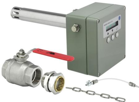
Según la opinión de los expertos aplicable, el hidrógeno, el monóxido de carbono y la humedad en el aceite aislante de transformadores de potencia son los indicadores tempranos primarios para posibles daños por causas térmicas y eléctricas en el transformador. MESSKO® MSense® x2.5 está centrado en estos indicadores tempranos y controla continuamente sus concentraciones
